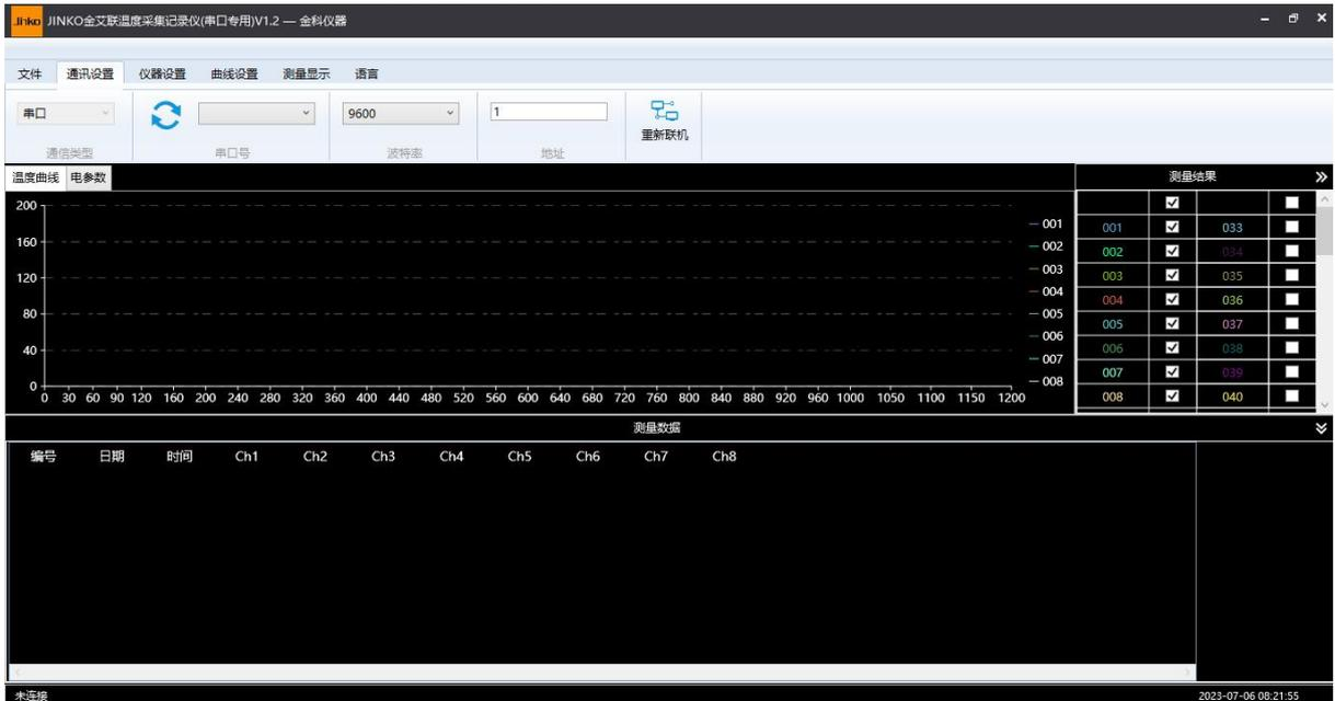
3. 点击仪器设置选项，进入仪器设置界面，该界面可以选择热电偶型号，需与设备所用热电偶型号一致，默认为K型热电偶；也可以调整温度单位，注意：该温度单位仅作单位作用，并不会对设备的数据进行相应换算，为避免出错需调整至与设备设置一致：
