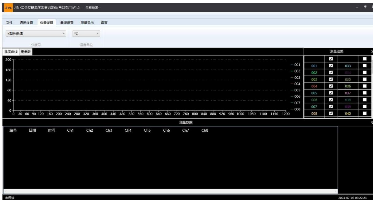
4. 点击曲线设置选项，进入曲线设置界面，曲线类型默认折线，其他无效；曲线宽度可选1~5像素控制曲线粗细；在实时测量开始前可以通过调整x轴间距设置x轴每格间隔，开始测量后改动无效；上下限设置可设置y轴显示范围；曲线追踪平滑滚动不生效，默认为整屏滚动；通过上移下移左移右移按钮查看实时曲线或打开的已储存曲线，复位按钮使曲线恢复原样：
