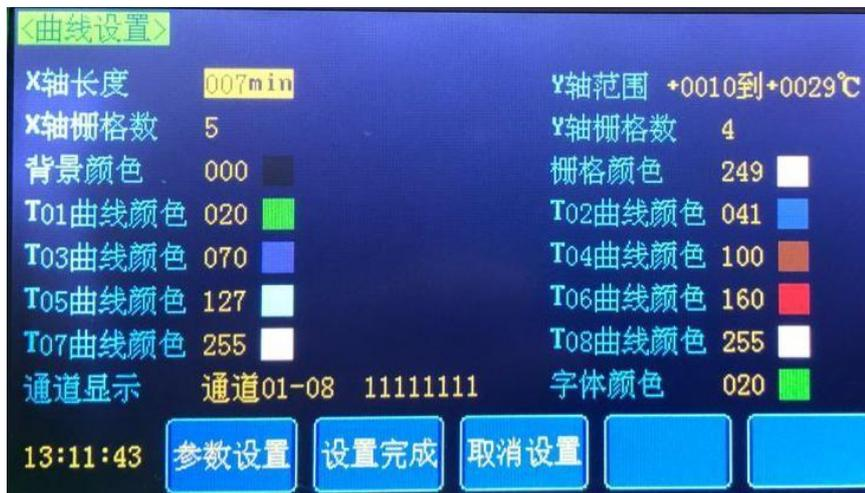
X轴长度：X轴时间值，1min~999min可自由设置。
