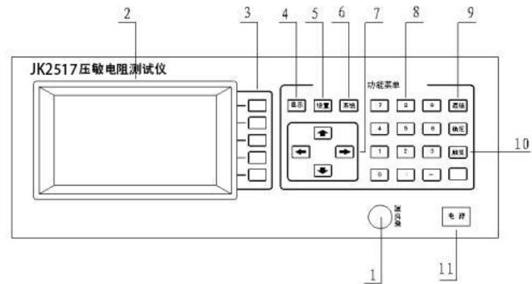
图 1： 2517 压敏电阻测试仪面板示意图
