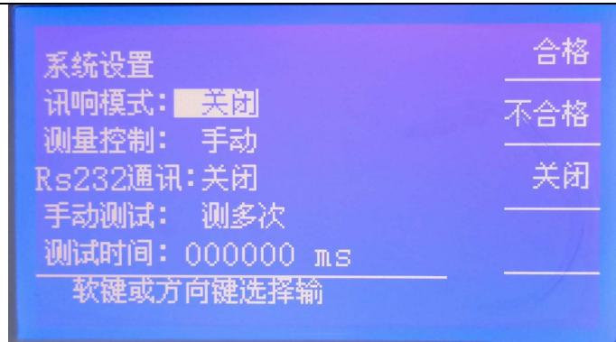
图 7：系统参数设置显示页面
