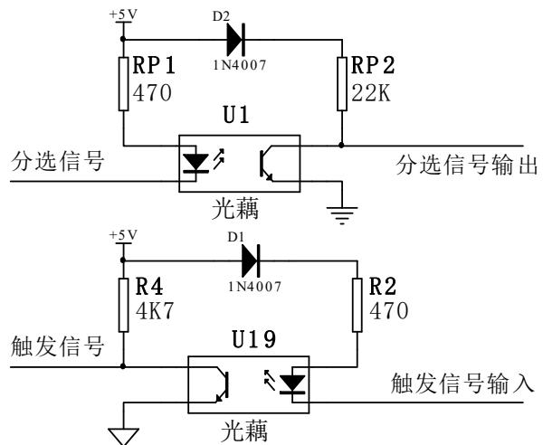
图 10: PLC 接口电路简图
