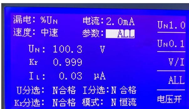
图 2：三参数时测量显示页面
