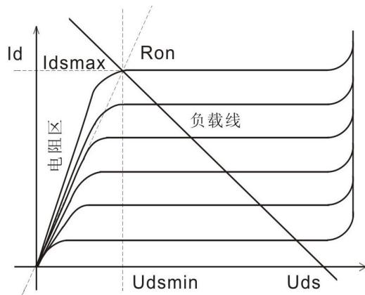
在 10V 棚极电压  $U_g$  下 Vmos 管由可调电阻区进入饱和区时的直流电阻为通态电阻  $R_{on}$ 。
