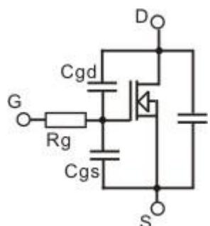
一般是在漏极加 10V 电压，棚极电压为 0V，测量出。大电流管主要是栅源极电容  $C_{irr}$ ，(有的叫  $C_{gs}$ )取决于激励功率。
