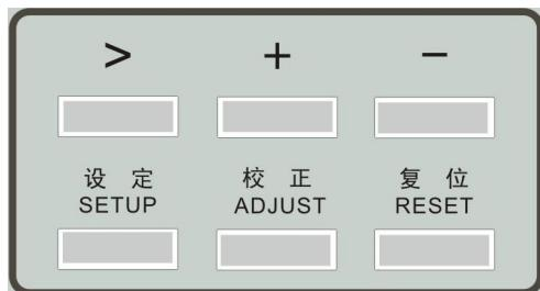
设定键(SETUP)，移位键(>)，加键(+)和减键(-)。
